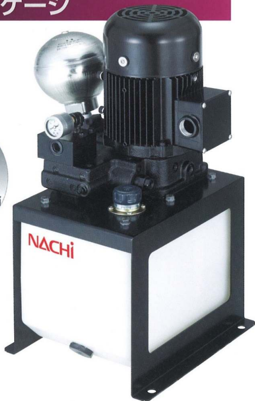
システム構成例(マシニングセンタクランプ)
